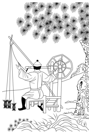
图3 《天工开物》中使用小纺轮的纺车并丝 [7]
