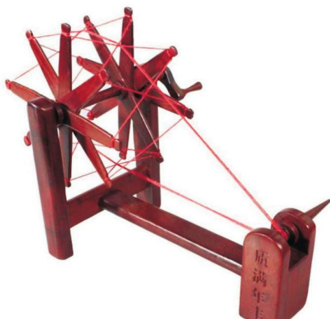
图 4 手摇纺车的结构
